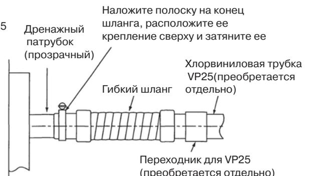
4. Закройте гибкий шланг теплоизоляцией, она должна плотно, без зазора доходить до внутреннего блока. Также необходимо теплоизолировать дренажную трубу, проложенную в помещении.
