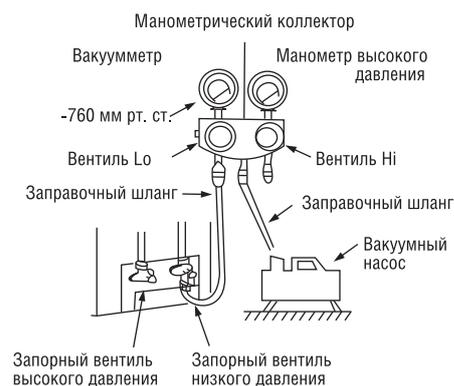
После завершения откачки полностью закройте вентиль Lo и выключите вакуумный насос. Проконтролируйте показания манометра, стрелка не должна отклоняться от значения достигнутого после остановки вакуумного насоса. Повышение давления свидетельствует о наличии негерметичности в системе. В данном случае необходимо найти и устранить негерметичность в системе и повторить процесс вакуумирования.
