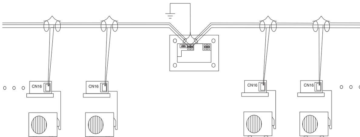
**Принципиальная схема подключения недельного таймера YCS-A001**
