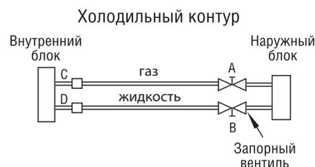
1. Подключите заправочный шланг манометрического коллектора к заправочному клапану запорного вентиля низкого давления (газовая труба).
