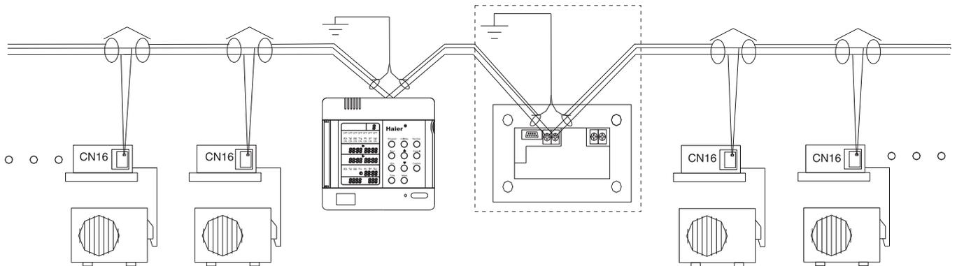
Принципиальная схема подключения согласователя работы YCJ-A001 с двумя кондиционерами
