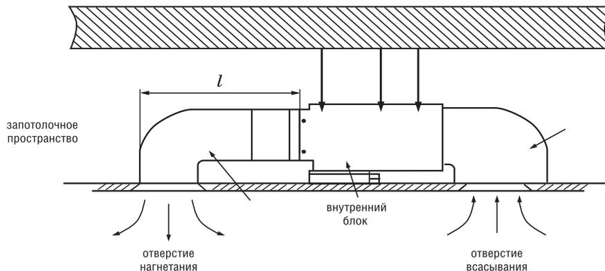
$l \leq 1$  м (подключение белой колодки – низкий напор);  $l \leq 5$  м (подключение красной колодки – средний напор)
