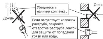
Все изгибы труб должны быть как можно более плавными. Для изгиба пользуйтесь трубогибами. Следует также учитывать возможность случайного повреждения. Если длина открытой части трубопровода превышает 1 м, то на эту часть следует установить обшивку на стяжных хомутах.
