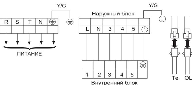
**HDU-42HF03: 6 x 2,5 мм<sup>2</sup>**, питание подается на наружный блок, дополнительно прокладываются провода подключения датчиков: разморозки наружного блока, и защиты по низкому давлению.
