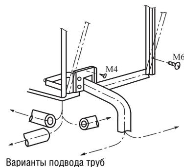
3. На высоте 2 м от блока не должно быть никаких помех движению воздуха. В противном случае необходимо установить адаптер, отклоняющий воздушный поток. При монтаже наружного блока оставьте достаточно места для технического обслуживания (не более 800 мм).
