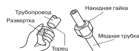
3. Отсоедините накидные гайки, прикрепленные к внутреннему и наружному блокам кондиционера. Затем установите их на трубки, с которых уже удалены заусенцы и надета теплоизоляция.
