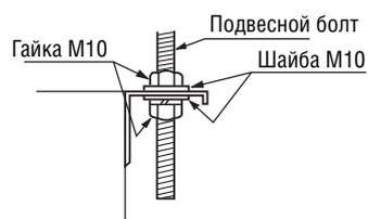
3. Наденьте подвесную скобу на монтажный болт и надежно закрепите ее сверху и снизу с помощью гаек с шайбами.
