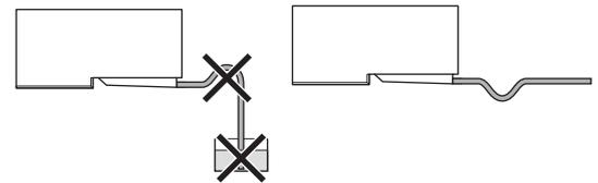
3. Твердую хлорвиниловую трубку нельзя непосредственно подключать к патрубку внутреннего блока – это может привести к повреждению патрубка или утечке конденсата. Для соединения используйте гибкий шланг.
