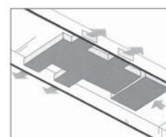
1. Длина воздуховодов подсоединяемых к внутреннему блоку зависит от номинальной скорости работы вентилятора (напора). У низконапорных моделей есть возможность выбора различных номинальных скоростей вентилятора.
