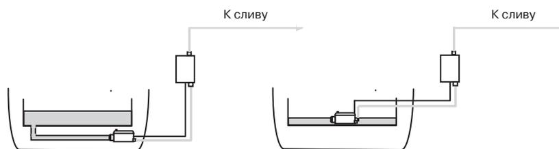
2. Наливные помпы. Эти помпы имеют достаточно большой накопительный резервуар, в который дренажная вода поступает самотеком. Помпа выполнена в виде одного блока, имеет достаточно большие габариты и устанавливается ниже дренажной ванны. Применяется с кондиционерами большой мощности или с группой кондиционеров.
