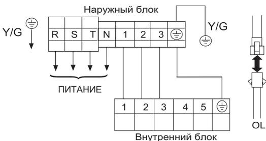
**HDU-42CF03/H: 4 x 2,5 мм<sup>2</sup>**, питание подается на наружный блок, дополнительно прокладывается провод подключения датчика защиты по низкому давлению.
