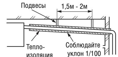
2. В дренажном трубопроводе не применяются гидравлические затворы. Не опускайте конец дренажного шланга в воду. Во избежание распространения неприятных запахов допускается установка сифона.
