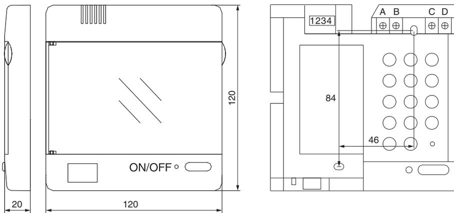
Просверлите два отверстия на стене в соответствии с расположением шурупных отверстий на задней крышке проводного пульта. Затем вставьте дюбели в соответствующие отверстия и прикрепите заднюю крышку проводного пульта двумя шурупами к стене.
